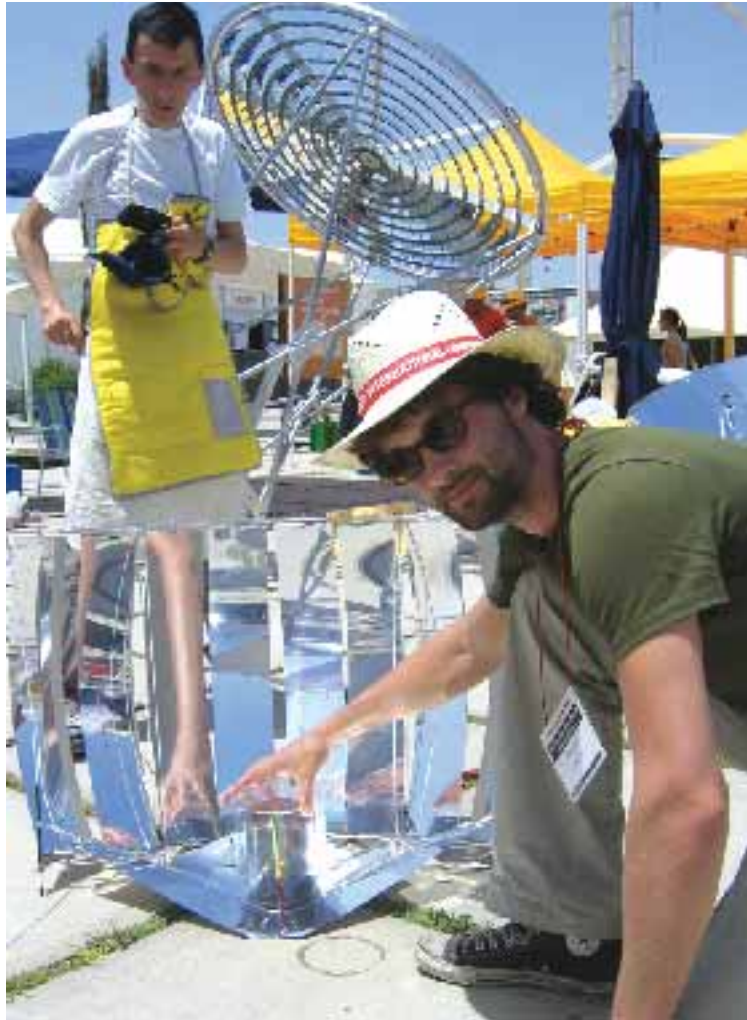
PROTOTYP. Daniel Philippen mit dem faltbaren Solarkocher. / B. E.
